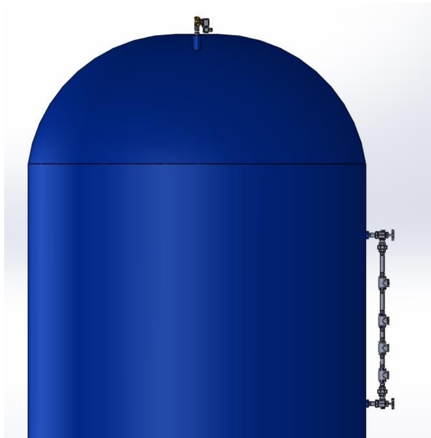
Fig. 52 Válvula solenoide y el sistema de automatización ensamblada en la cámara de aire.
