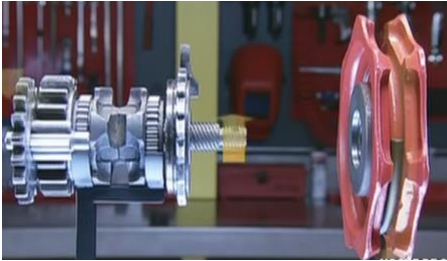
Figura 21. Vista interna del polipasto.
