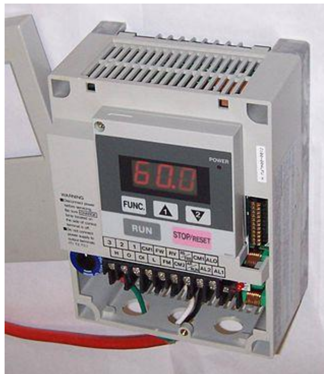
Figura 50. Variador de frecuencia.
