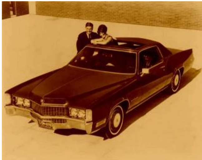
Figura 3 Primer techo solar incorporado a un automóvil cadillac.
