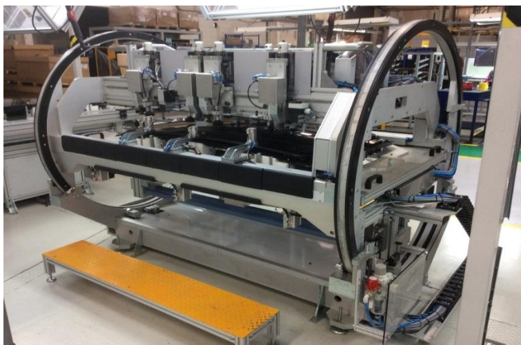
Figura 67 Máquina de ajuste de atornillado en fase terminal montada.
