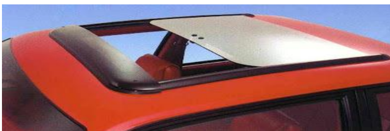
Figura 9 Tipo de techo solar Top-mount.
