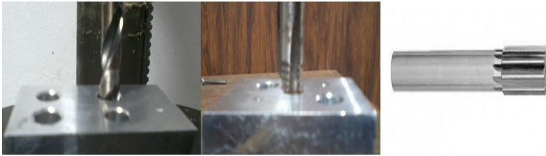
Fig.101 Barrenado, machueleado, rimado.
