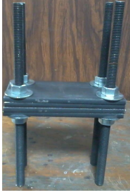
Fig. 99 Base de la viga.
