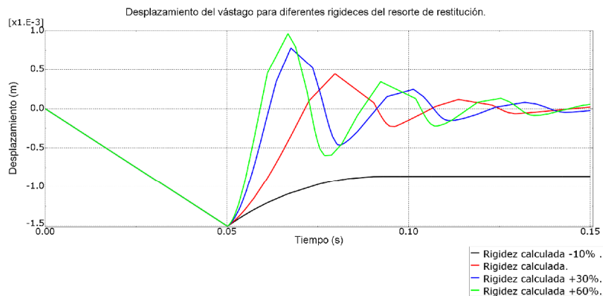
Fig. 79 Desplazamiento en el vástago para diferentes rigideces del elemento de restitución.
