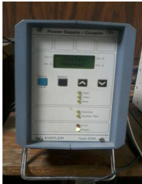
Fig.108 Acoplador de señales.
