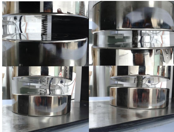
Fig. 96 Caracterización de resortes en máquina de tensión-compresión.
