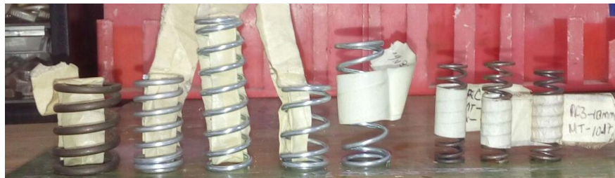
Fig. 94 Resortes sometidos a compresión para obtener su rigidez.
