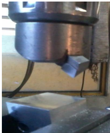
Fig.100 Desbaste de material para realizar los diferentes ángulos.
