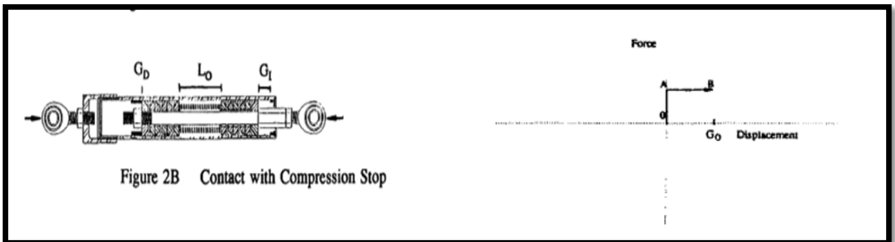
Fig.37 Desplazamiento inicial, contacto con tope.
