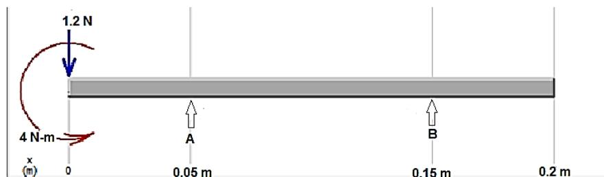
Fig 14. Diagrama de cuerpo libre del eje
