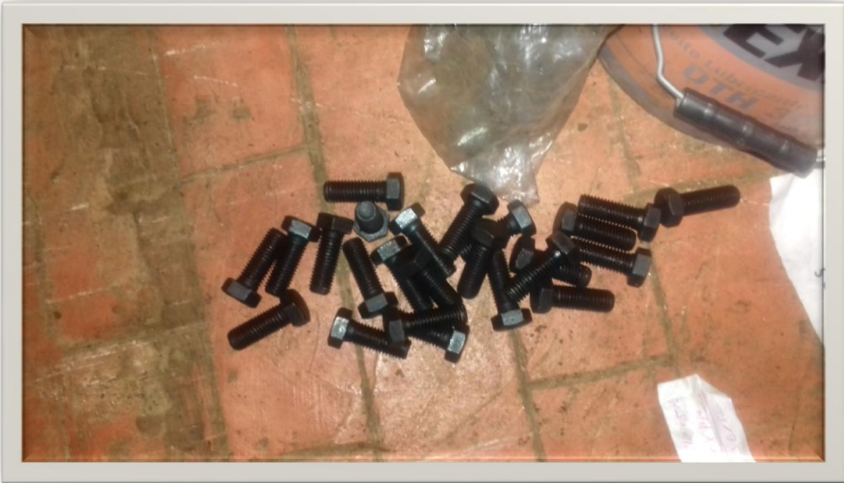
Figura 34. Tornillería para cimentación de las bombas centrifugas
