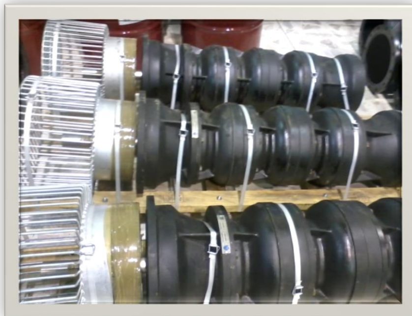
Figura 25. Tres Bombas con canastilla
