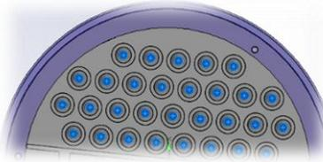
*Imagen 166 Flujo volumétrico a la salida de la cúpula de cono.*
