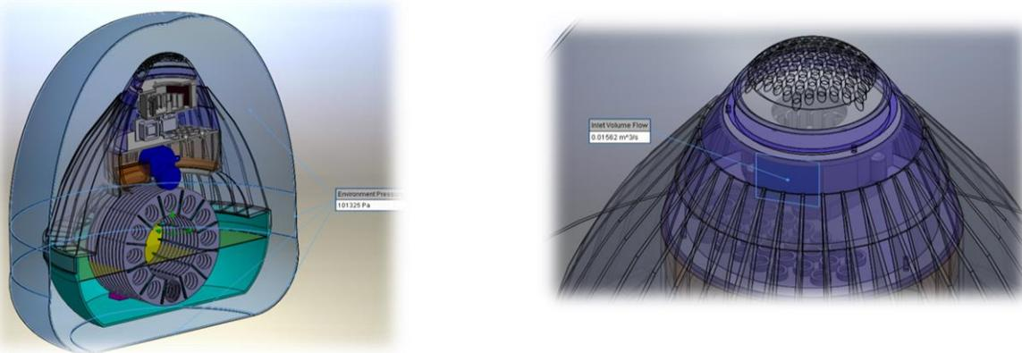
*Imagen 91 Tapas sometidas a la presión atmosférica y salida de aire.*
