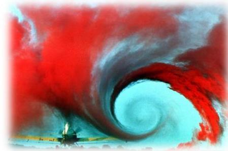
*Imagen 196 Vórtice generado por el paso de un ala de avión, revelado con humo coloreado.*
