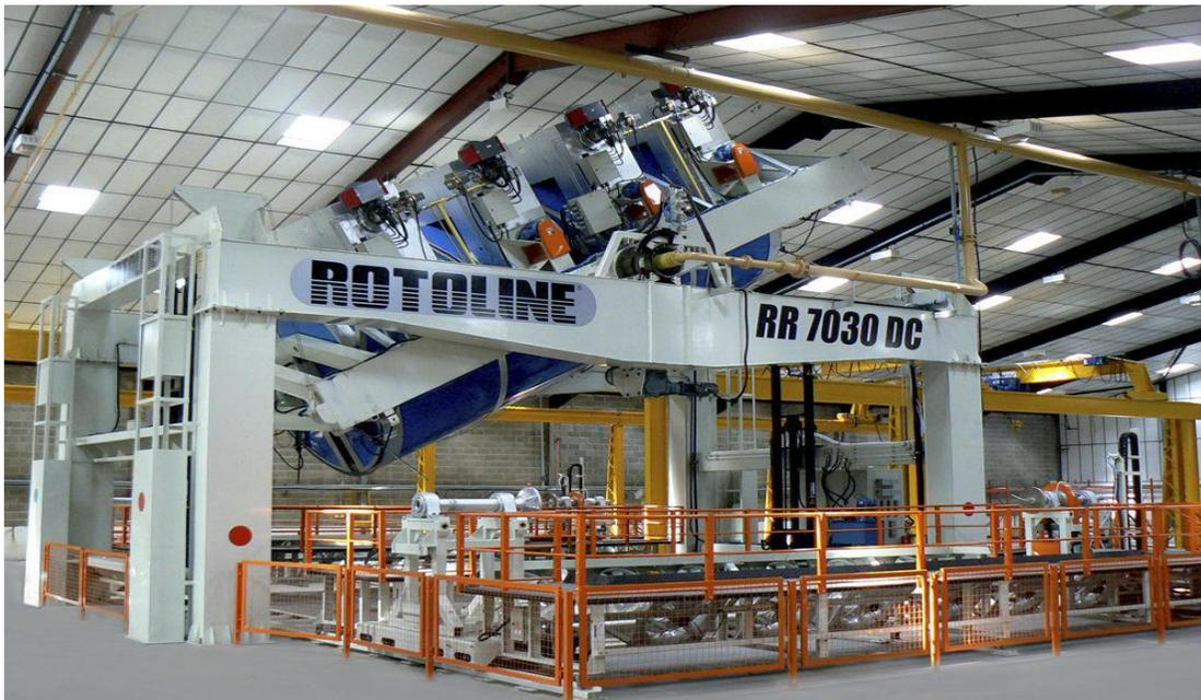
FIGURA 25. MAQUINA DE ROTOMOLDEO BASCULANTE ROCK AND ROLL EN DESCANSO
