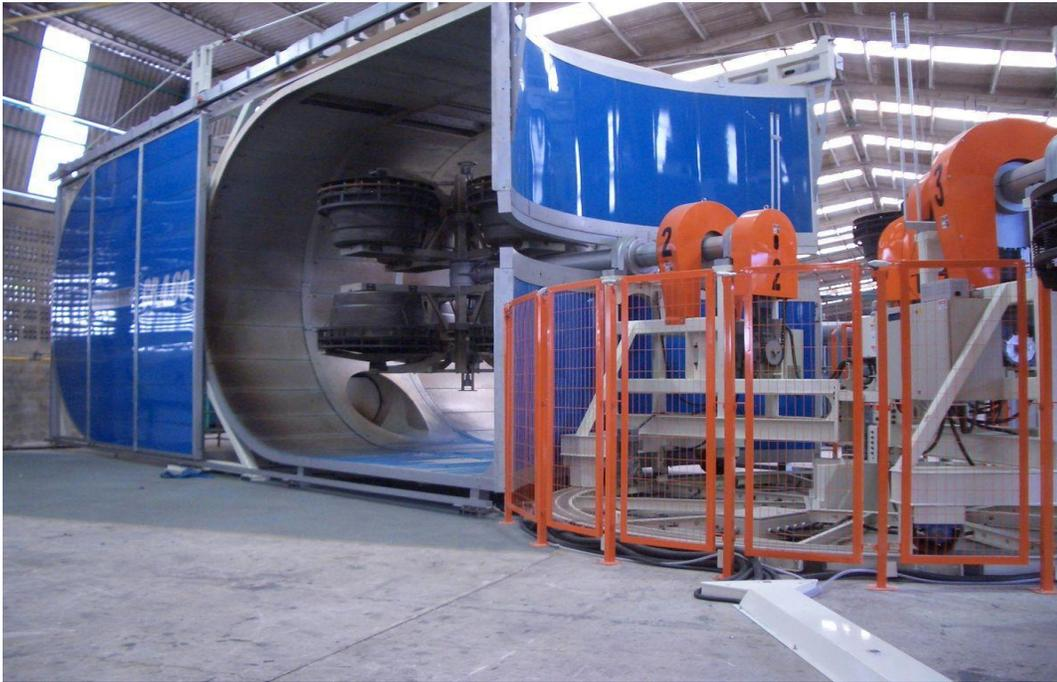
FIGURA 26.MAQUINARIA DE ROTOMOLDEO DE TIPO CARROUSSEL
