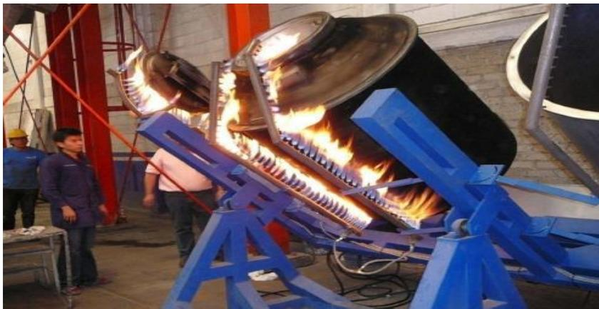
Figura 21. MAQUINA DE ROTOMOLDEO DE FLAMA ABIERTA EN USO
