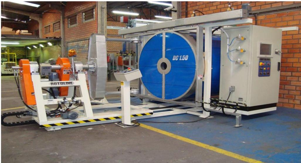
FIGURA 23.MAQUINA DE ROTOMOLDEO LINEAL
