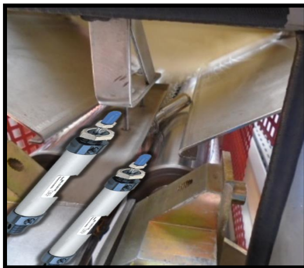
Imagen 31 "Representación sencilla del sistema de pistones"
