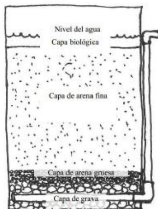
Figura 3. 15 Filtro casero para agua.
