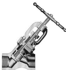
Imagen 4.4.3.II.4. Válvula de globo en “Y” permite flujo rectilíneo.
