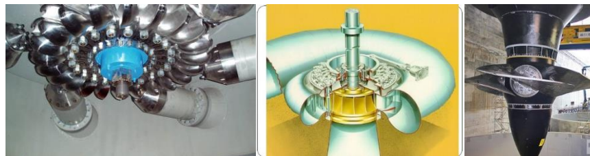
Imagen 4.1.2. Turbina a) Pelton, b) Francis y c) Kaplan
