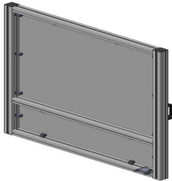
Figura 55.- Ventana de mantenimiento.
