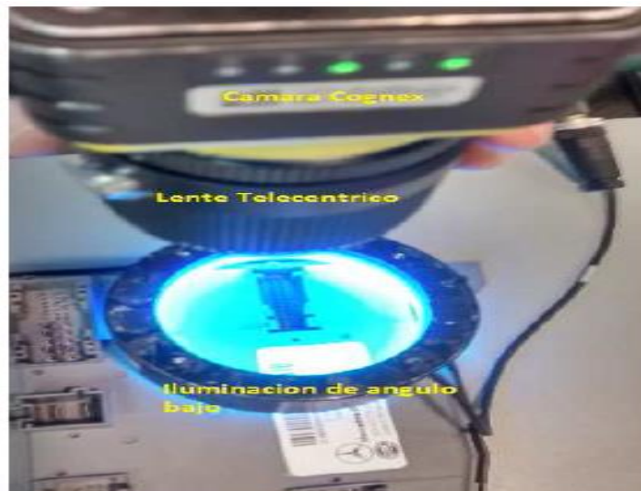
Figura 7.- Sistema óptico de verificación de pines ubicados en los conectores.
