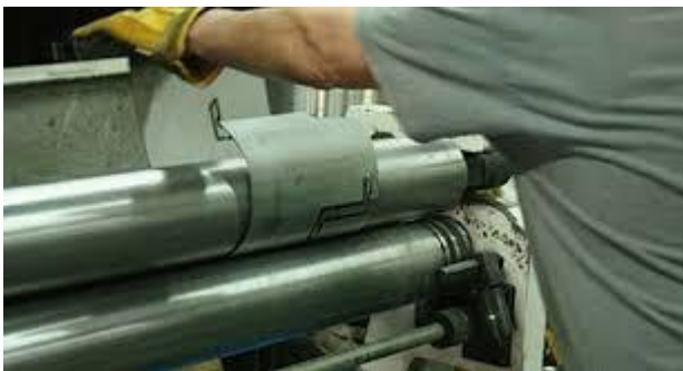
Figura 3.6 Uso de máquina para rolado de material.
