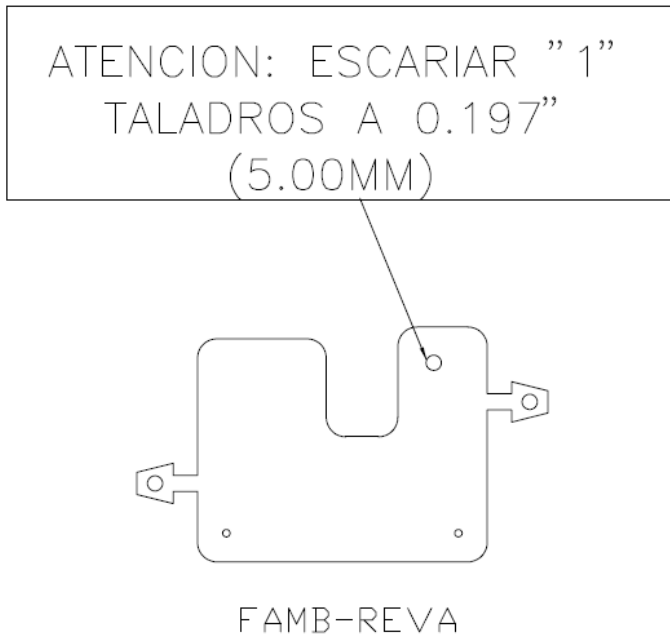
Figura 5.11 DXF definido para part number de la familia B
