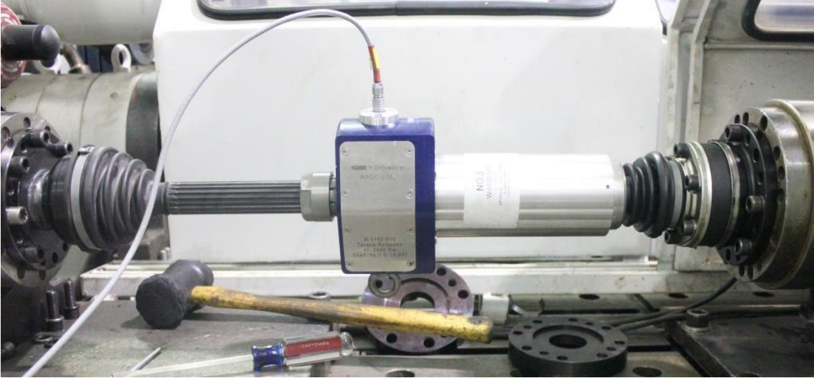
Figura. 3 Equipo actual para la calibración de torque en banco de fatiga
