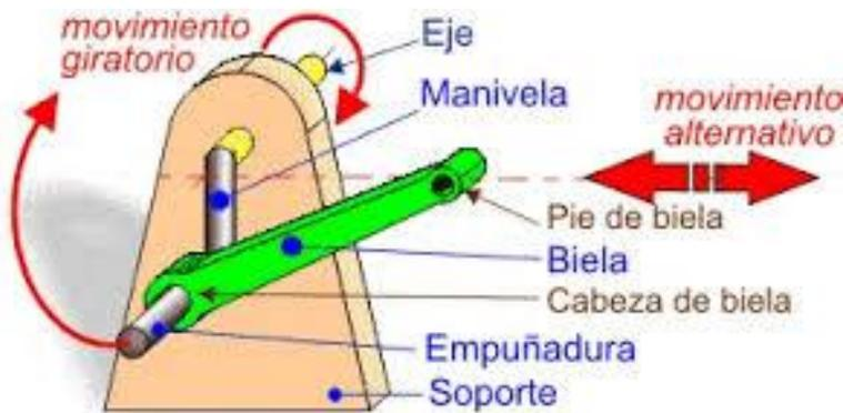
Ilustración 4-7 Mecanismo de Biela-Manivela
