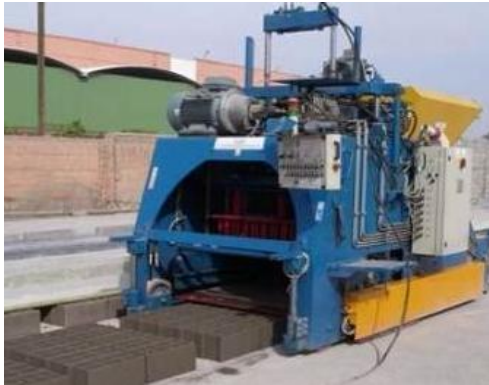
Figura 22. Máquina bloquera móvil. Fuente [31].
