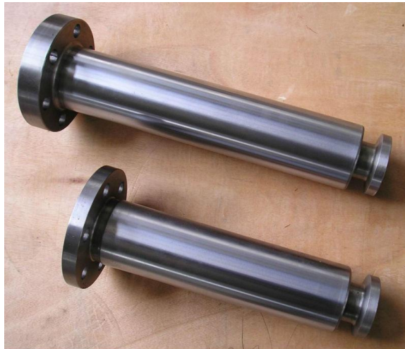
Figura. 3.14 Barra de extensión
