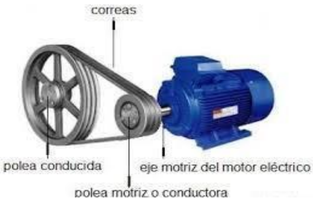
Figura 3.19 Parte e transmisión externa de una bomba
