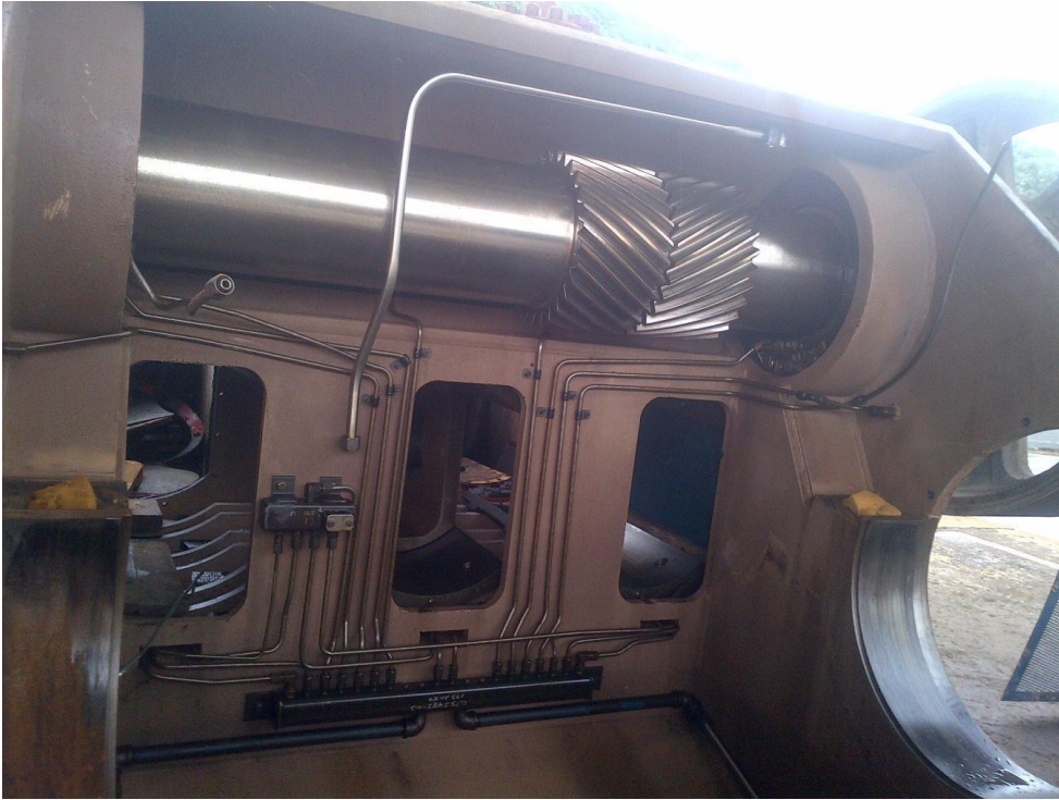
Flecha piñón y sistema de lubricación
