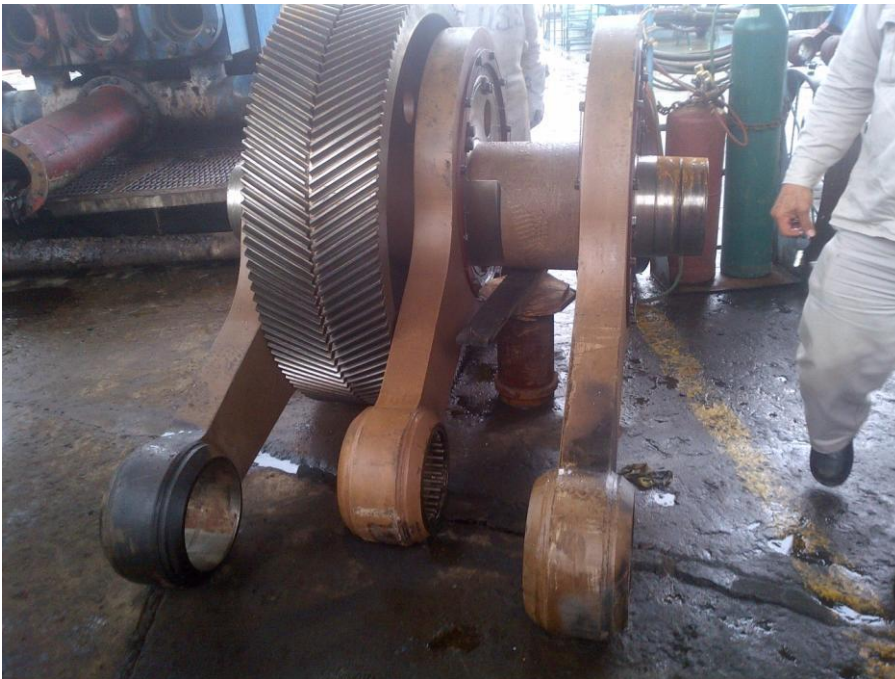
Engrane corona, eje del cigüeñal , buelas y rodamientos de la biela
