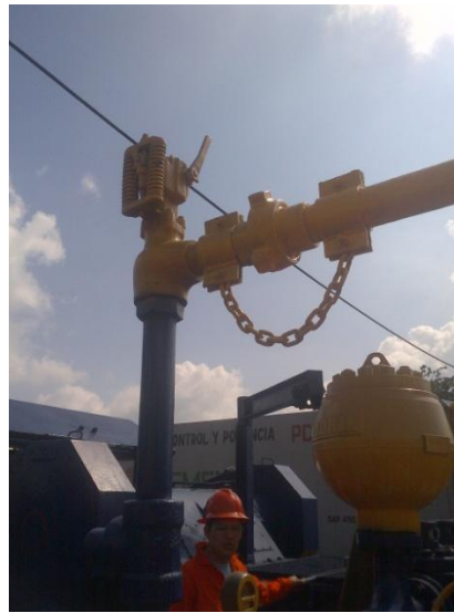
Figura. 3.18 Válvula de alivio de presión
