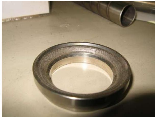
Figura. 3.10 Asientos de la válvula
