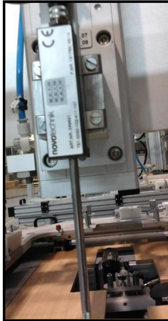
Figura 36 LVDT ensamble en el sistema de medición
