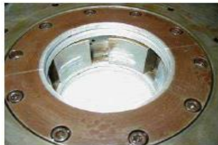
Figura 2.22. Ejemplo de cojinete radial.
