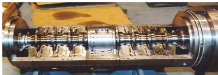
Figura 2.27. Imagen real de un barril (back-to-back).
