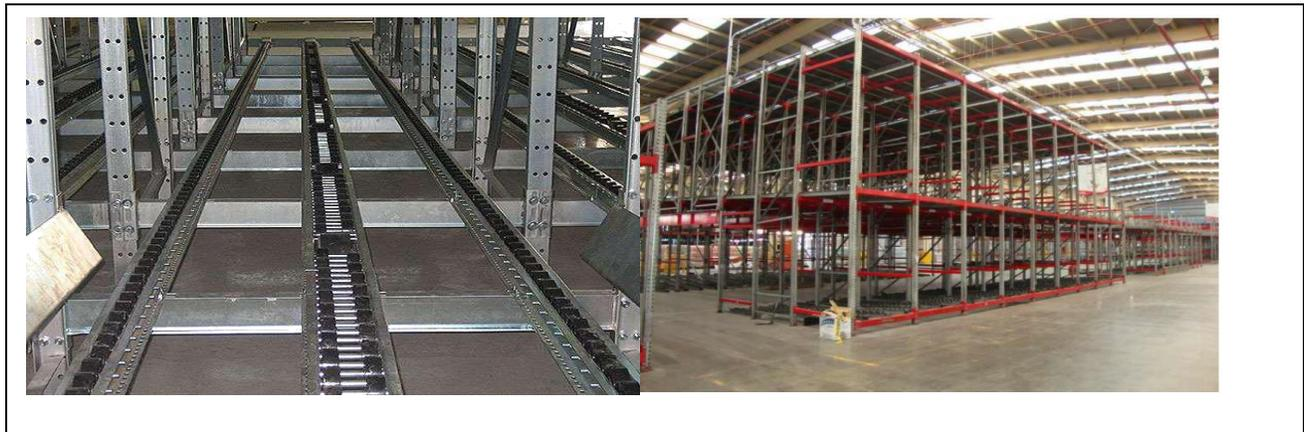
Figura 21 – Modelo de racks dinámicos
