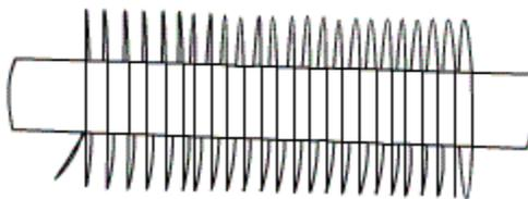
Figura 5 Tubo con aletas transversales
