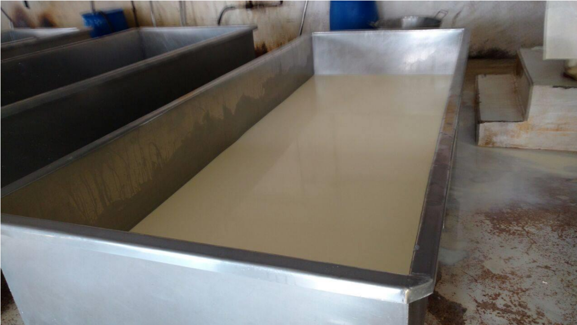
FIG. 2.5 TINA DE ALMACENAMIENTO EN EL INTERIOR DEL AREA DE QUESERIA
