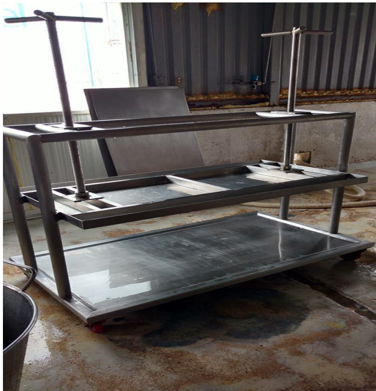
FIG.3.8 PRENSA ACTUAL CON DOS TORNILLOS QUE EJERCEN LA PRESIÓN
