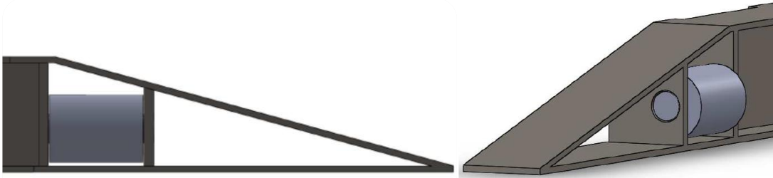
Ensamble 4. Instalación de rodillo.
