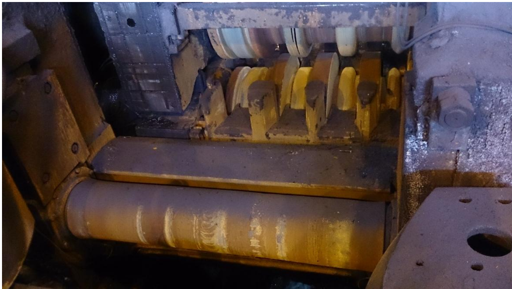
Fotografía 8. Desgaste de rodillo de entrada al Molino 1
