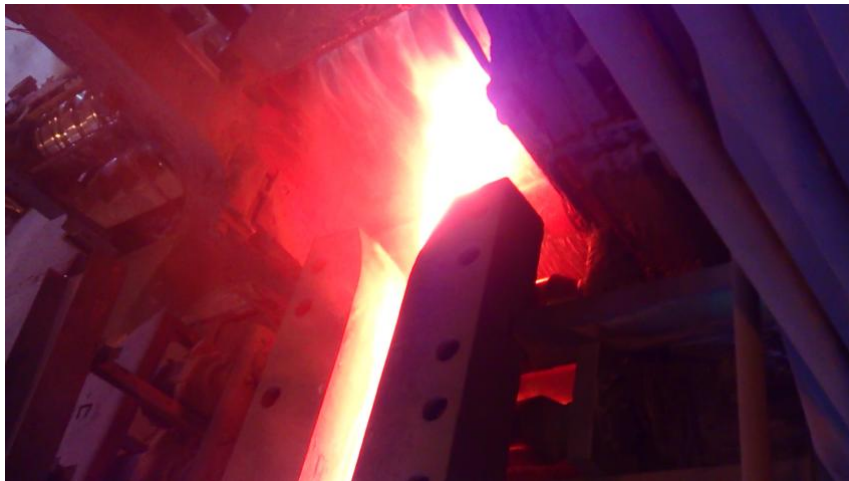
Fotografía 2. Cortina de agua aplicada a los rodillos en el proceso de rolado.
