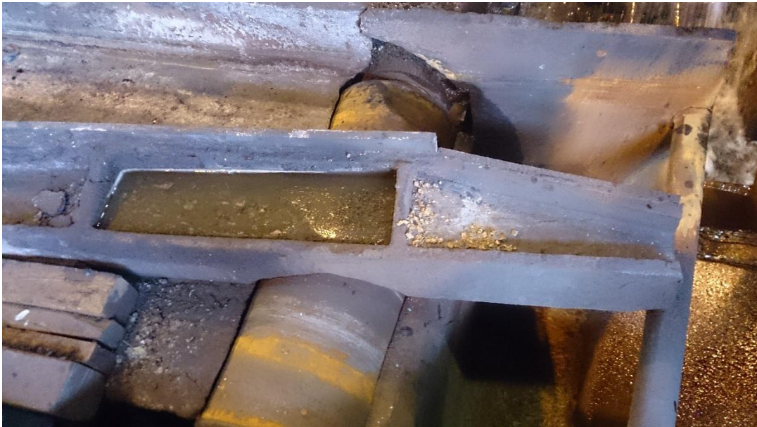
Fotografía 9. Deflector de salida de sierra 1.
