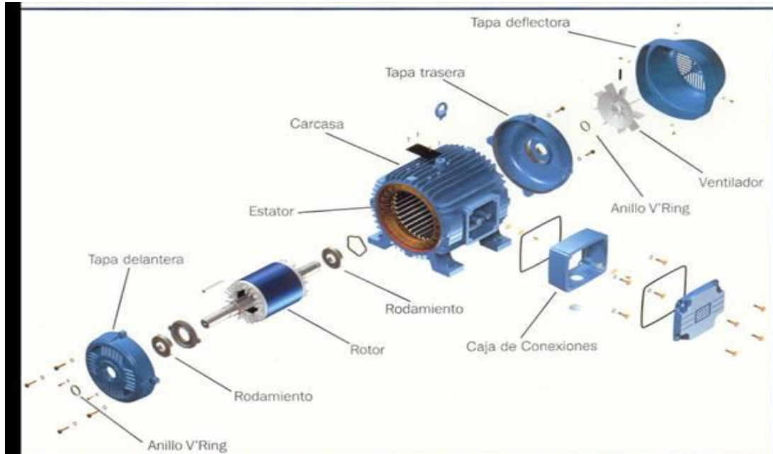
Figura 57: Motor de inducción con rotor de jaula de ardilla.
