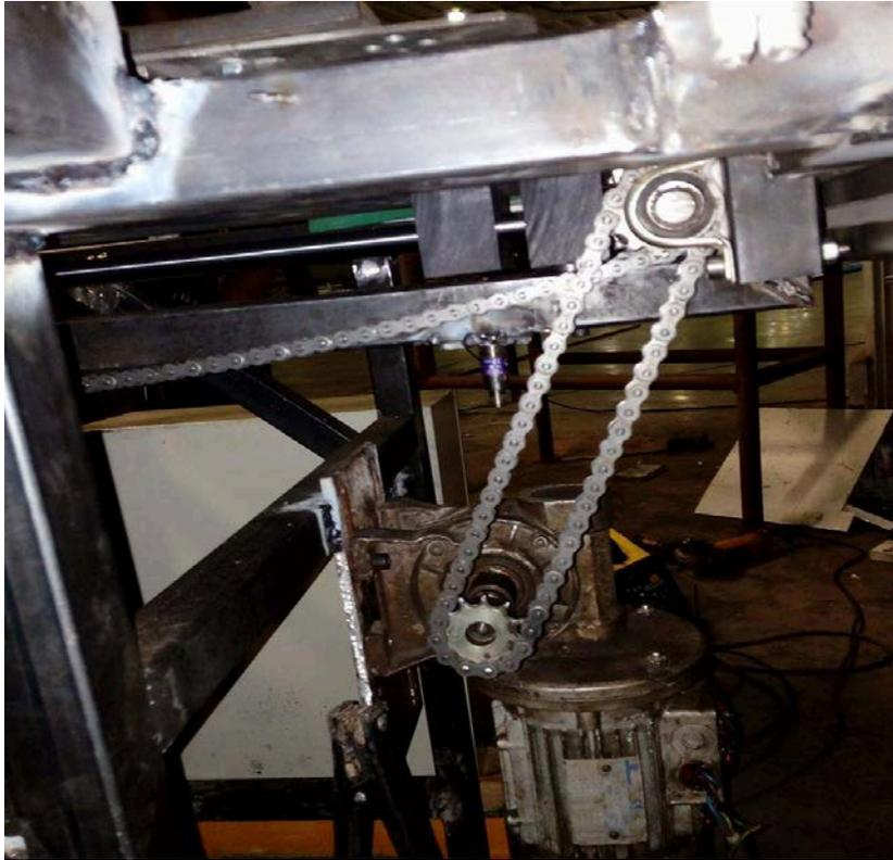
Fig. 69 Montaje de motor y catarinas motrices.
