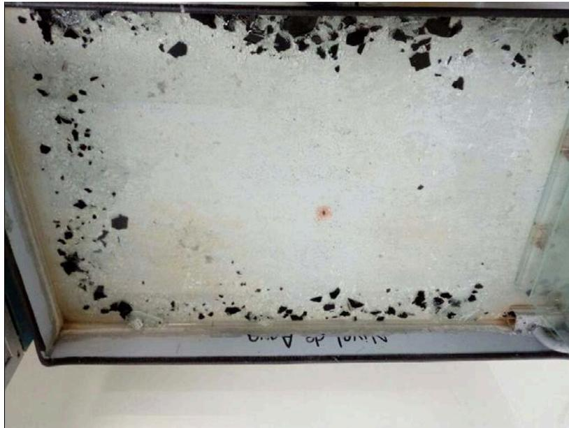
Fig. 85 fragmentos de un cristal defectuoso.
