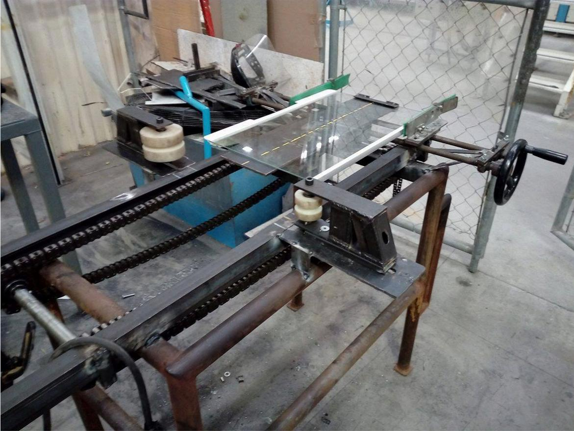
Fig. 61 Mecanismo prototipo finalizado y virolas maquinadas en Glasser.
