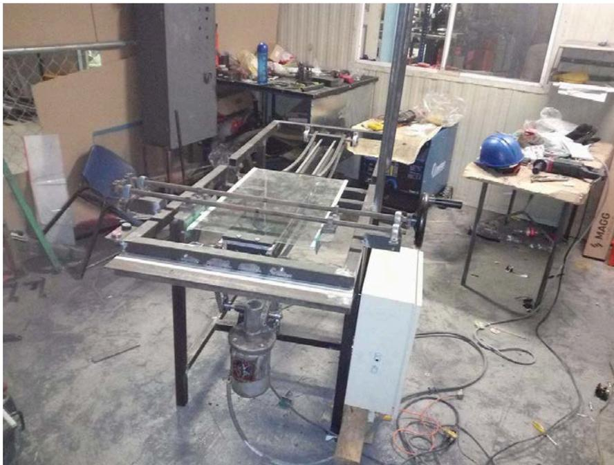
Fig. 72 montaje gabinete, conexión del motor, botones de adelante y retroceso de la base móvil y sensores.
