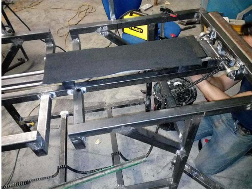
Fig. 67 Colocación de cadenas.
