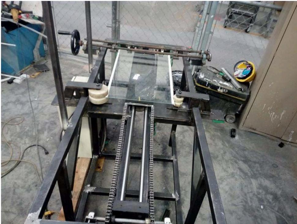
Fig. 70 Montajes del centrador de vidrios y violas.
