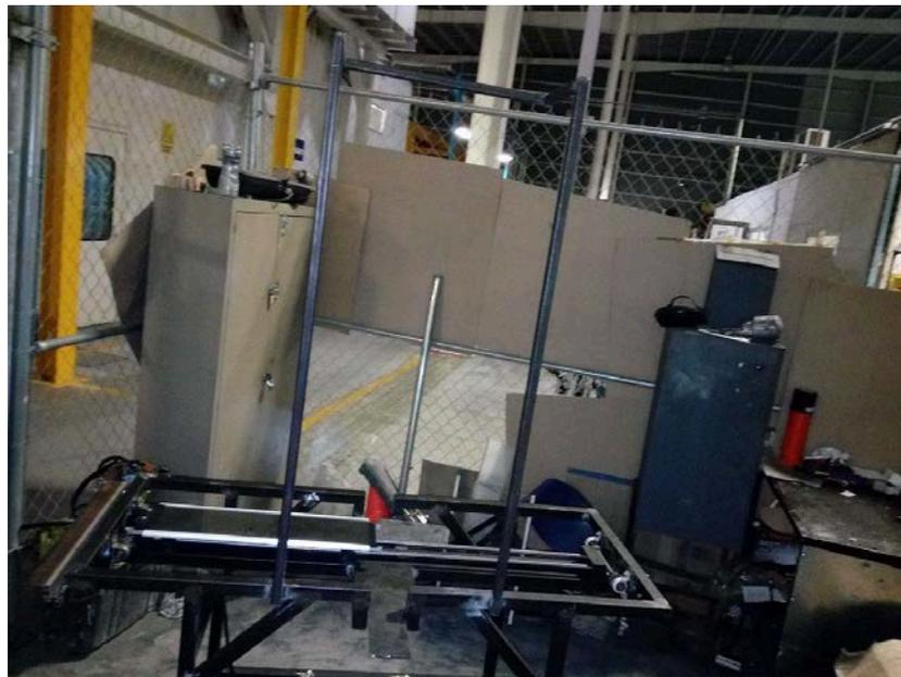
Fig. 66 Colocación de soporte de lámpara, chumaceras y base móvil del vidrio
