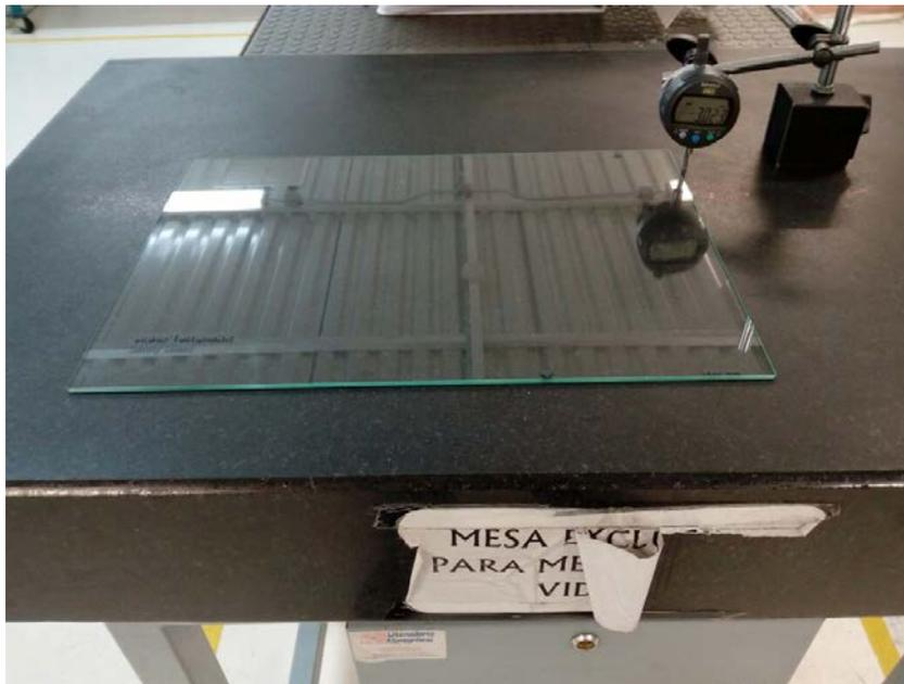
Fig. 80 RELOJ PALPADOR DE PLANICIDAD ELECTRONICO.
