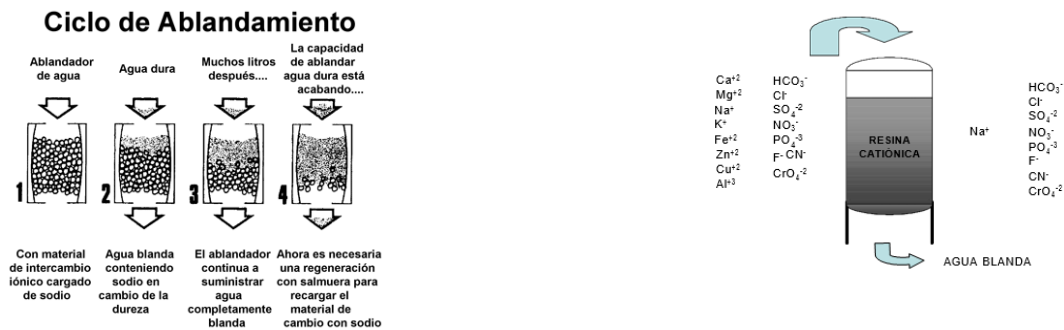
Figura 2.8 Tanque con resinas de intercambio iónico en ciclo sodio, para ablandamiento del agua, al intercambiar sodio por otros cationes, cuando fluye el agua y se pone en contacto con la resina.
