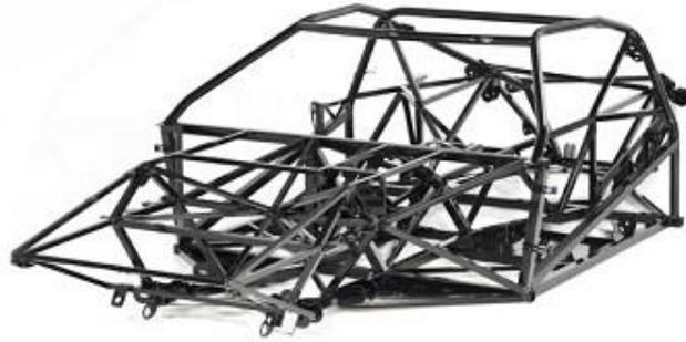
Figura 13 Bastidor tubular.
