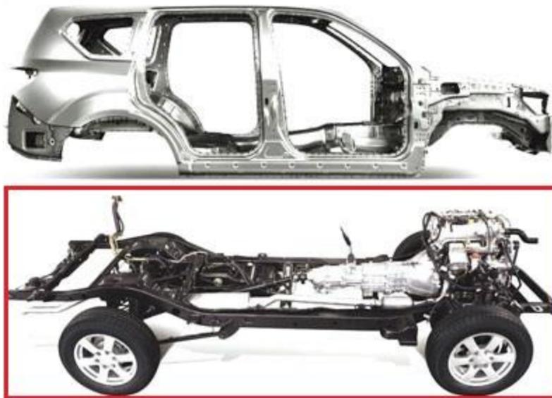
Figura 8 El bastidor independiente es comúnmente usado en vehículos todoterreno y camiones pesados.
