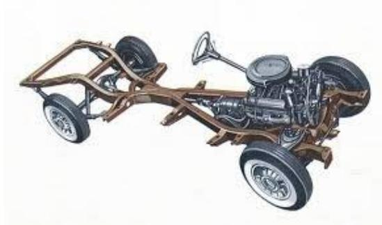
Figura 11 Bastidor en columna.
