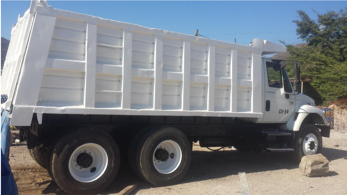
Figura. 47. Camión volteo 14 m 3 vista lateral derecha, dimensión defensa a defensa 6.8 metros.
