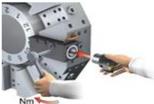
Figura 3.26. Sistema de cambio rápido CAPTO en el cual se cambia toda la herramienta de corte (no sólo el inserto de corte).
