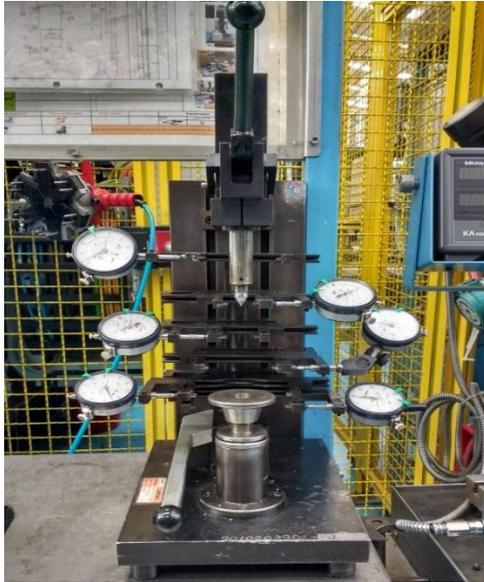
Figura 3.9. Calibrador para medir diámetros de las puntas de flechas homocinéticas.
