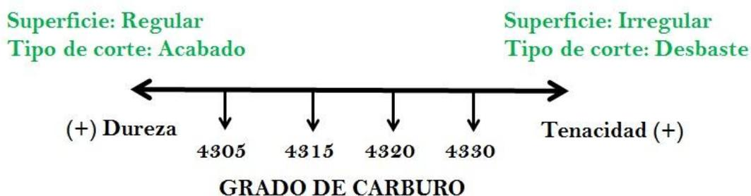
Figura 3.6. Grados de carburo según la superficie de la pieza.
