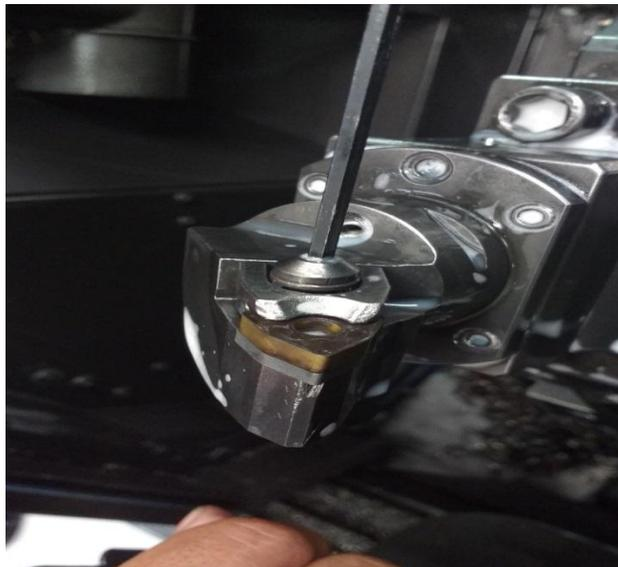
Figura 3.21. Cambio de filo de inserto manualmente por un operador de tornos.
