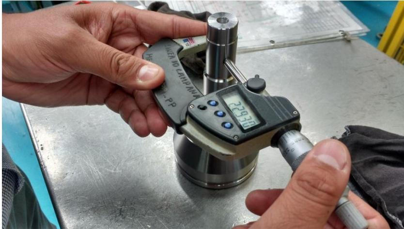
Figura 3.11. Medición de diámetros mediante un micrómetro.
