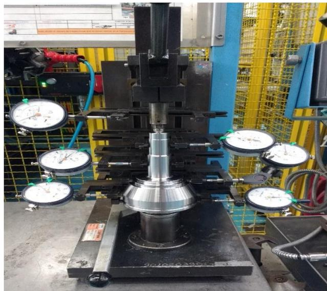
**Figura 3.23. Medición de diámetros de una punta de flecha homocinética.**
