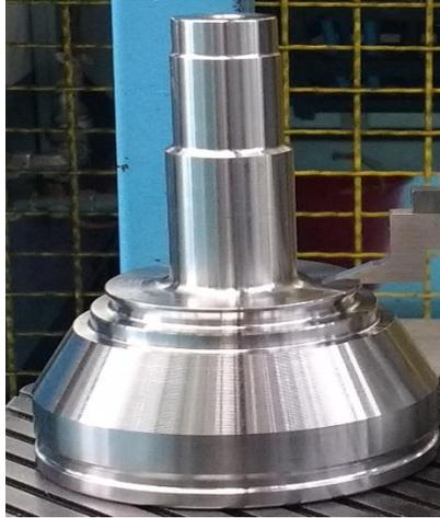
**Figura 2.6.** Punta de flecha homocinética después del torneado exterior.
