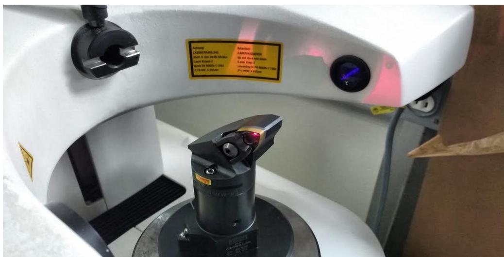
Figura3.26. Medición de herramientas utilizando el DMG MORI MICROSET.
