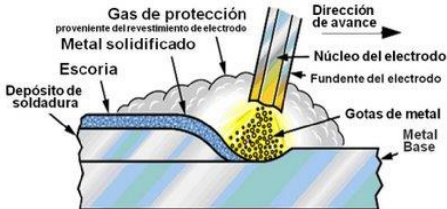
Figura 2.5 Soldadura de arco metálico con protección de gas.
