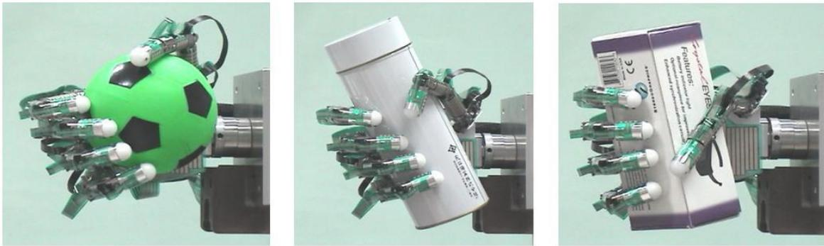
Figura 2.36 Ejemplos de agarre esférico, cilíndrico y prismático de la GIFU Hand III
