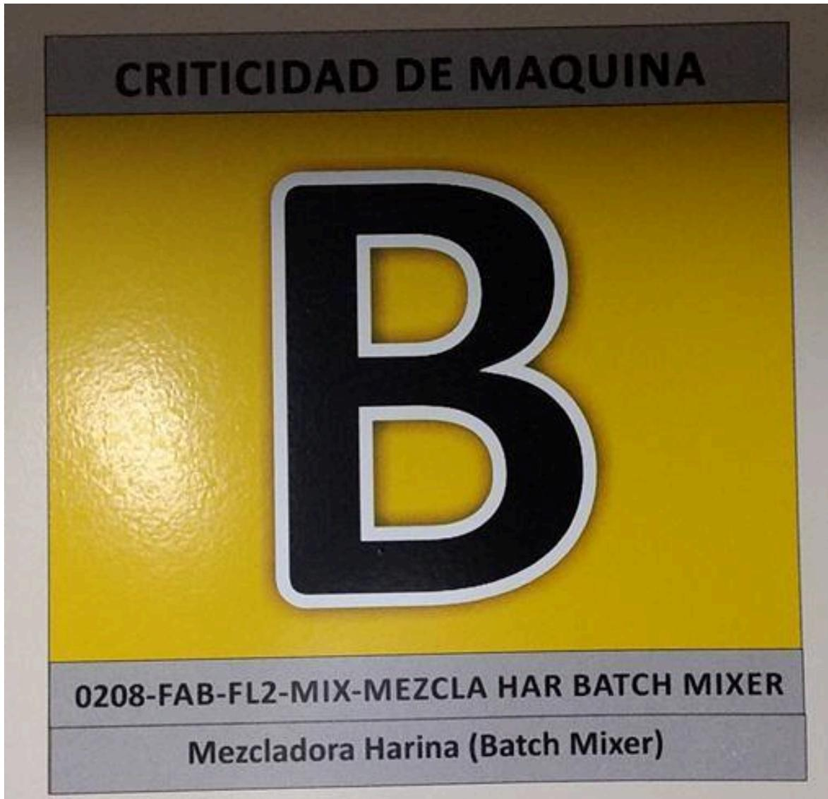
Ejemplificación de la ubicación técnica y grado de criticidad de una maquina de producción.
