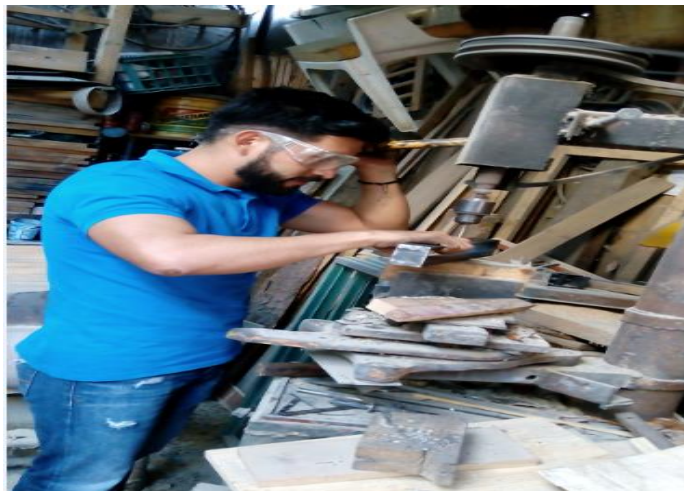
Ilustración 29 perforación del tensor de transmisión.
