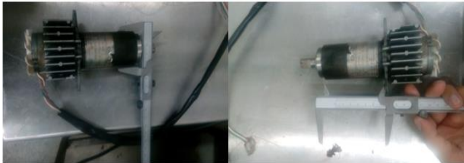
Ilustración 14 Toma de medidas de la circunferencia del motorreductor.
