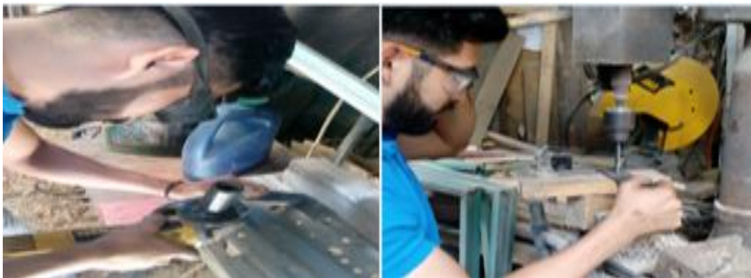
Ilustración 27 perforado y cortado de las bases de chumaceras.
