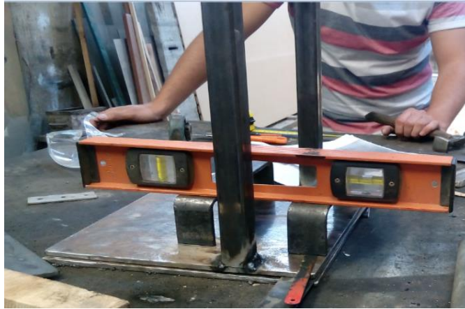
Ilustración 28 nivelación de bases antes de soldarlas al banco.
