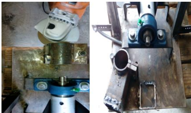
Ilustración 33 modificación de altura del soporte de motorreductor.
