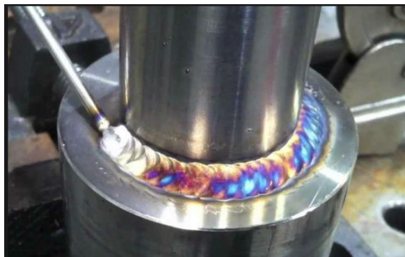
Ilustración 10 ejemplo de soldadura.
