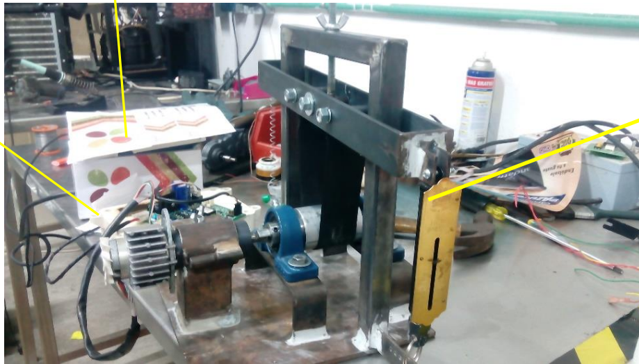
Ilustración 34 pruebas del banco con un motorreductor y el probador de tarjetas.
