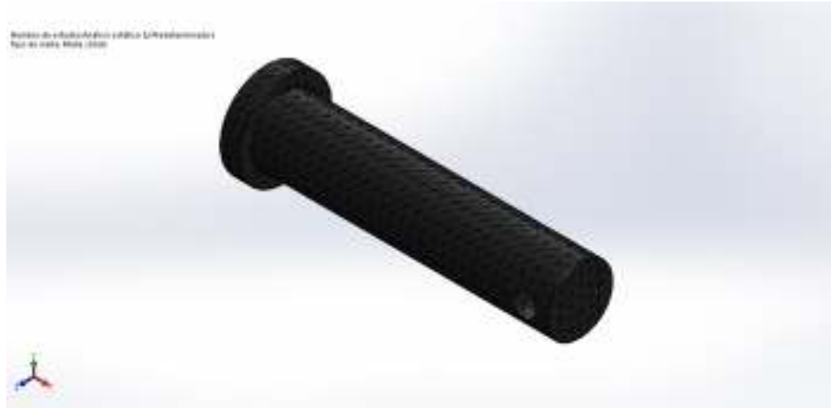
Figura 156. Generación de malla solida estándar con elementos cuadráticos de alto orden.
