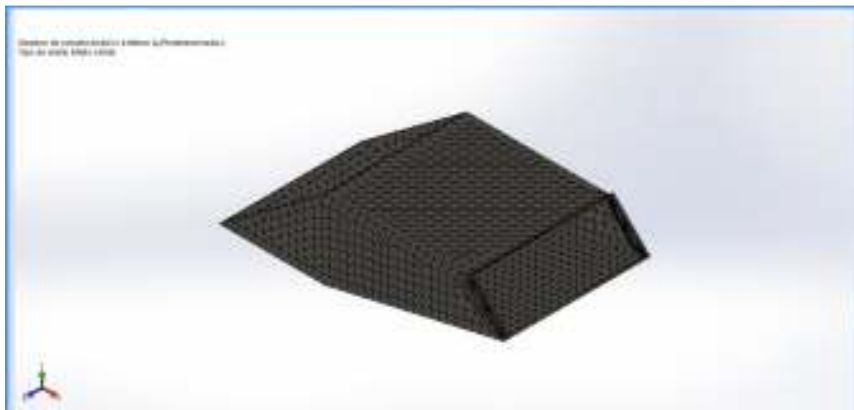
Figura 68. Mallado estándar de tolva de alimentación.
