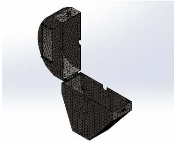
Figura 115. Generación de mallado solido basado en curvas.
