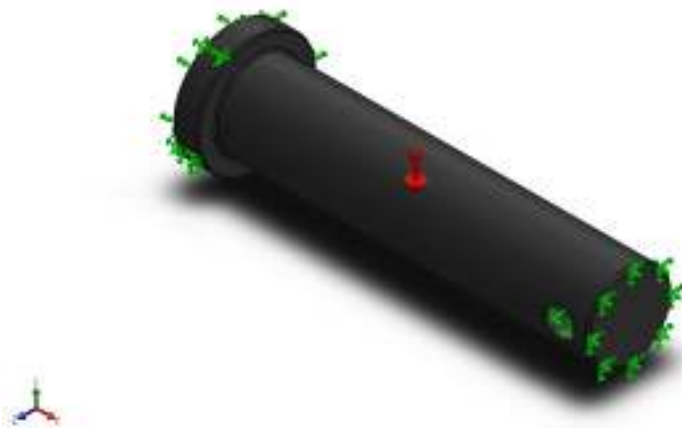
Figura 155. Colocación de cargas.
