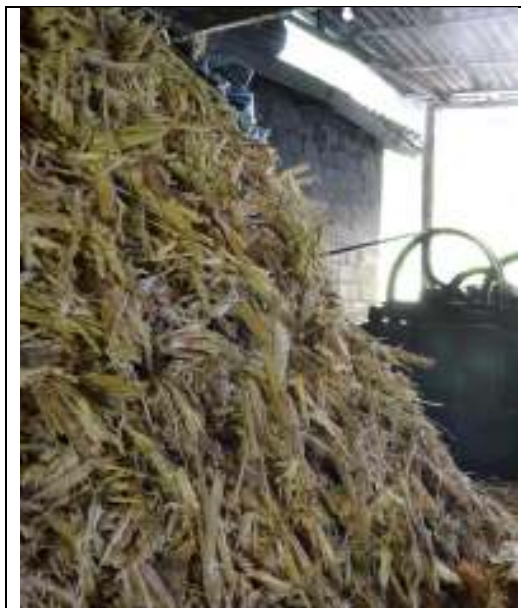
Figura 27. Bagazo de caña de azúcar después de la extracción de su jugo.
