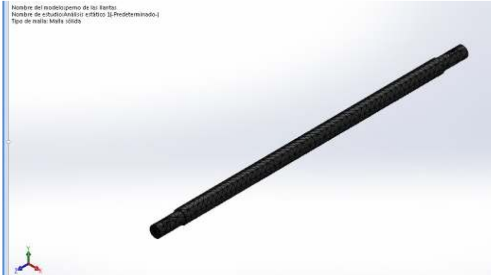
Figura 88. Generación de malla solida basada en curvas.
