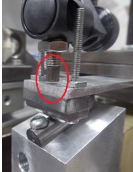
Figura 4.1 Posición del sensor ferromagnético para para indicar el contacto.
