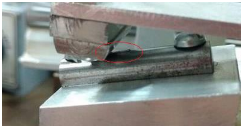
Figura 4.9 Marcas de desgaste en la zona de contacto.
