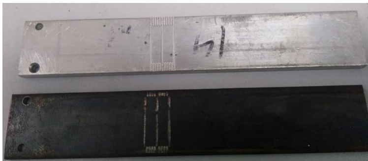
Figura 2.8 Vigas de diferentes materiales utilizadas para variar la rigidez en el sistema.
