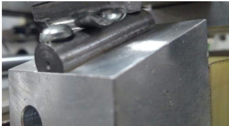
Figura 2.10 Probeta acoplada en la parte superior de la cuña.
