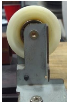
Figura 3.4 Polea de apoyo en la cual desciende la carga lentamente.
