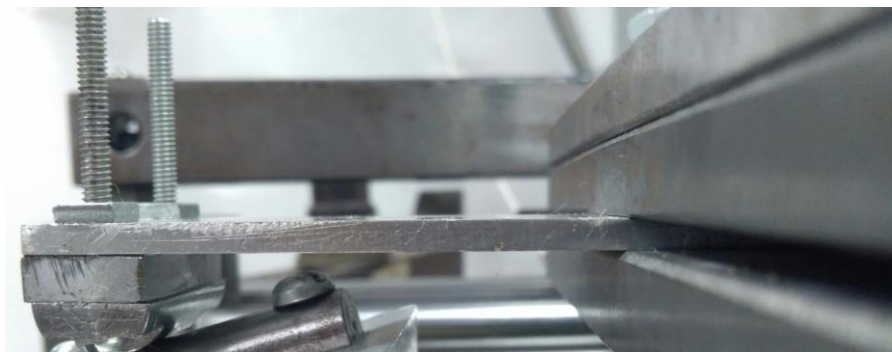
Figura 2.11 Viga en voladizo con una probeta acoplada en el extremo.
