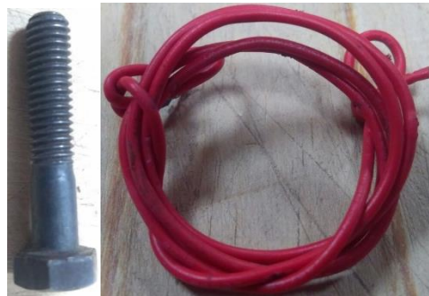
Figura 3.2 Elementos para acoplar la masa en la cuña donde: a) Tornillo que se acopla a una de las caras de la cuña, b) Cable.
