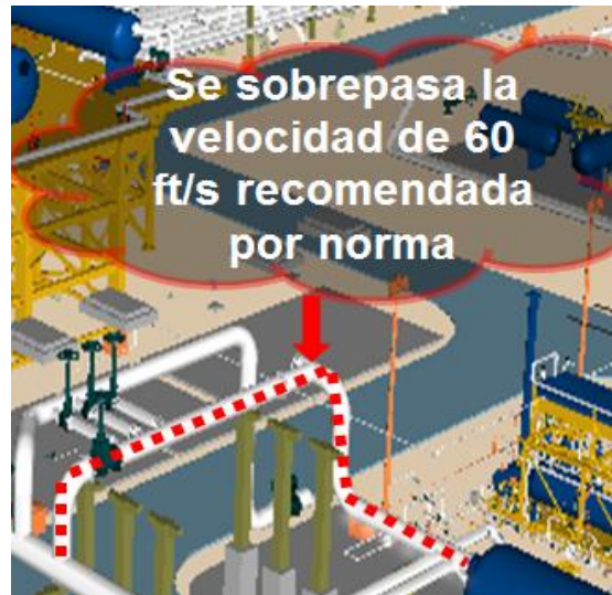
Fig. 21 Simulación en Olga de velocidad del fluido en cabezal de 36” y tubería a analizar.
