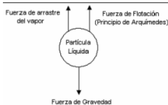
Fig. 7 Fuerzas que actúan sobre la partícula del fluido.
