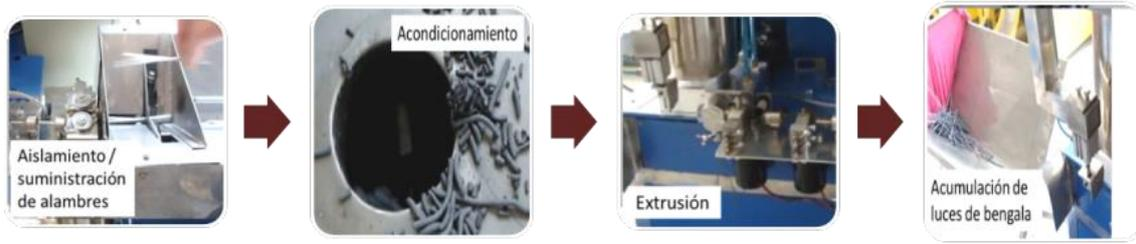
Figura 11.- Procedimiento utilizado para elaborar bengalas por el método de extrusión.
