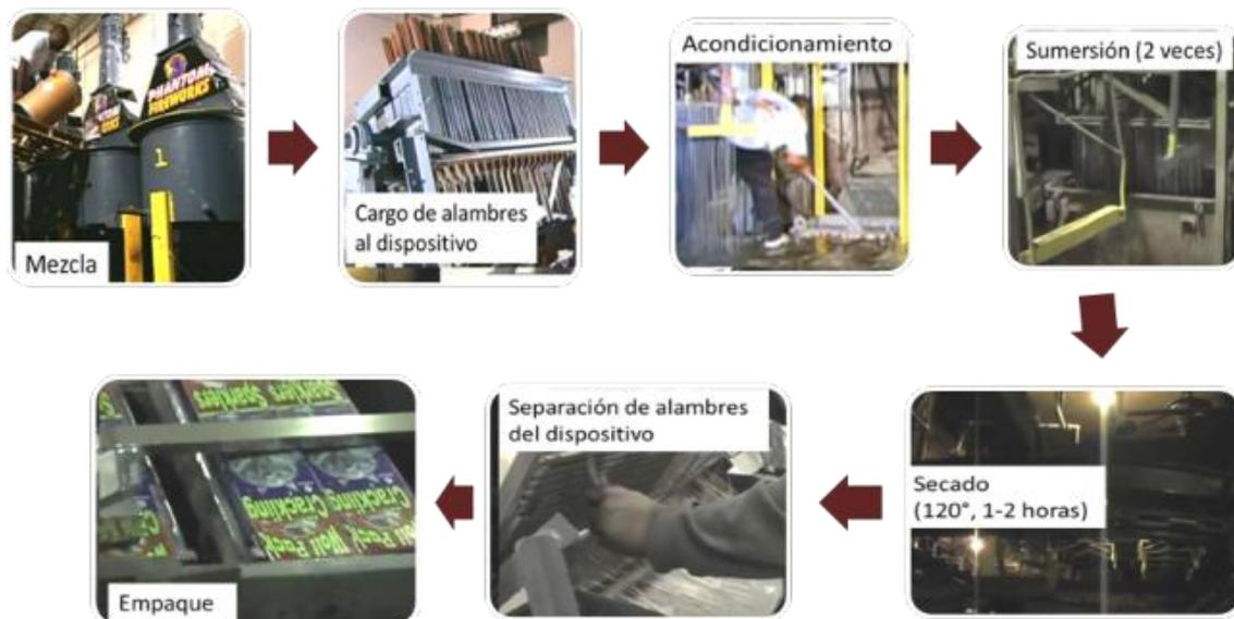
Figura 8.- Proceso de elaboración de bengalas común utilizado por empresa solicitante de la maquinaria
