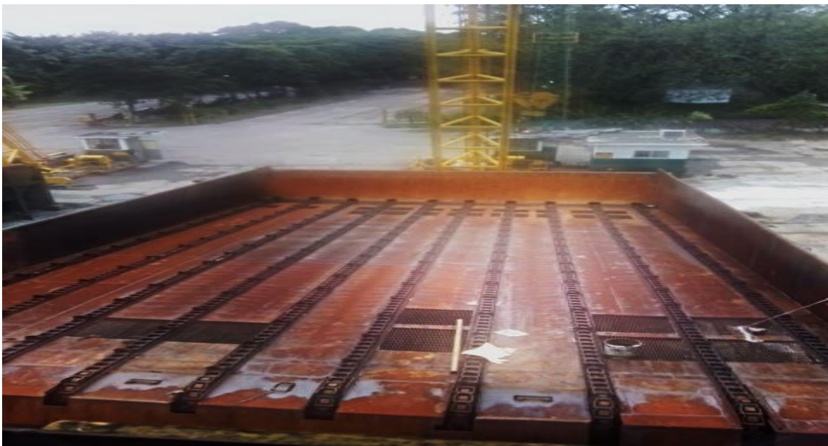
Fig. 4.15 Mesa alimentadora No.2 de 17.27 x 10.0 metros
