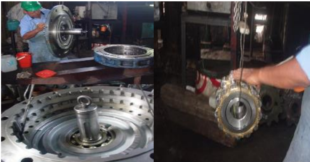
Fig. 4.18 Imágenes de baleros siendo desmontados del reductor
