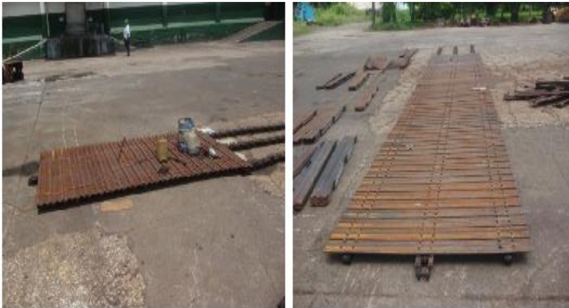
Fig. 4.20 Banda de acero del conductor de caña No.1
