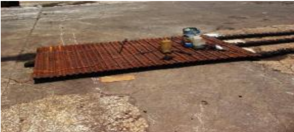
Fig. 4.25 Parte de la banda metálica del conductor de caña No.2
