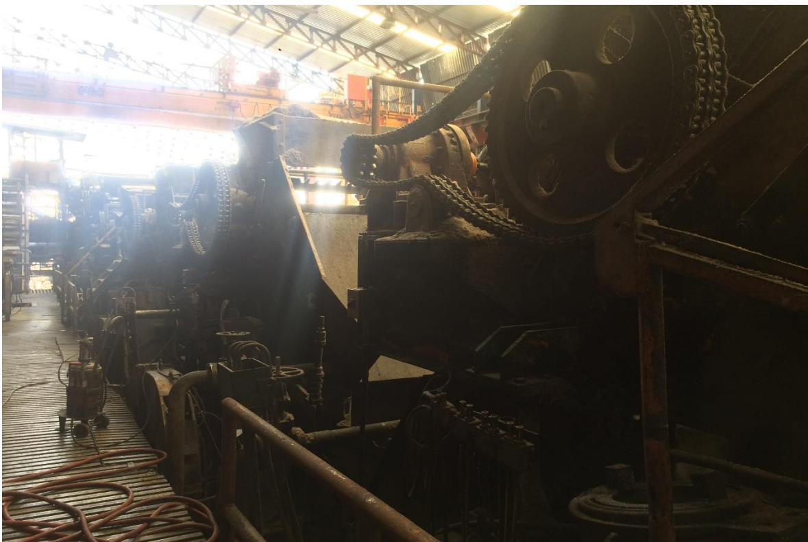
Fig. 2.3 Imagen de los molinos conectados en serie
