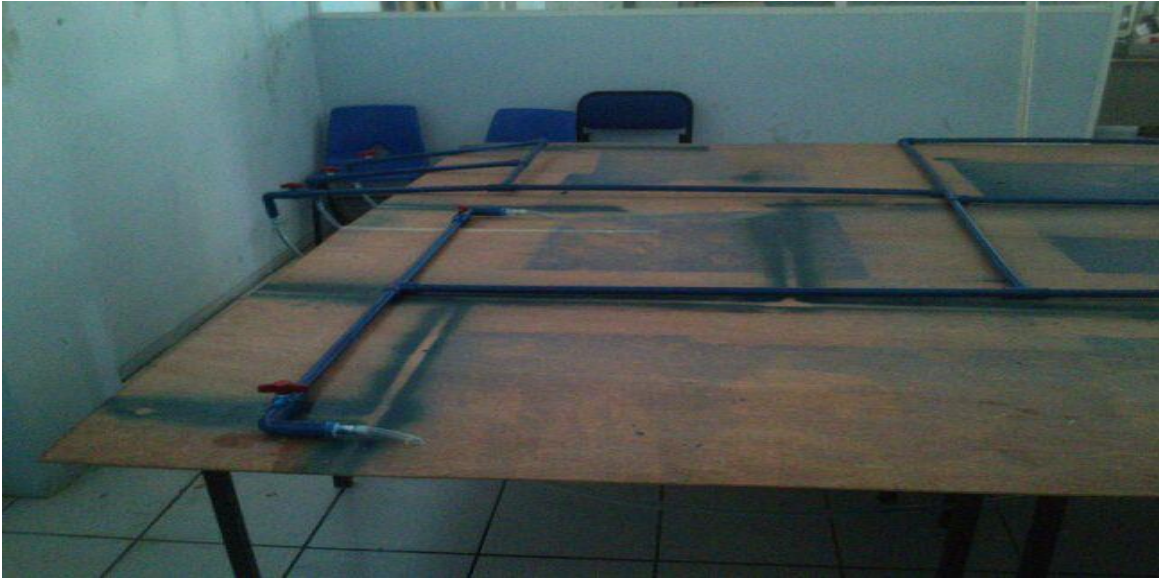
Fig. 4.7 vista de la red con capa de pintura azul
