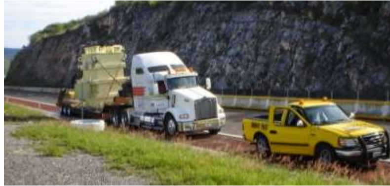
Figura 58. Vehículos piloto para transporte de maquinaria pesada
