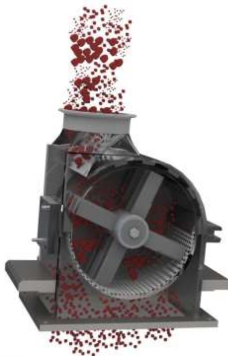
Figura 20. Representación básica del funcionamiento del molino de martillos
