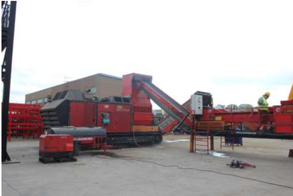
Figura 4. Trituradora metálica NZS HEM 1250 HAMMEL Recyclingtechnik GmbH®
