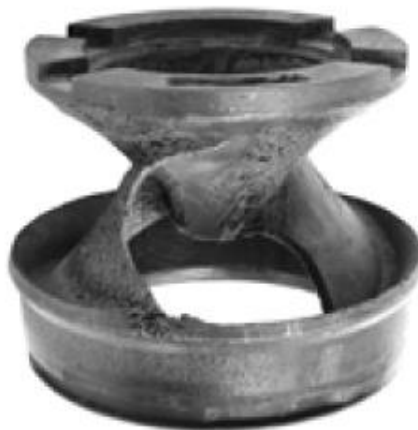
Figura 29. Impulsor con corrosión típica por cavitación.
