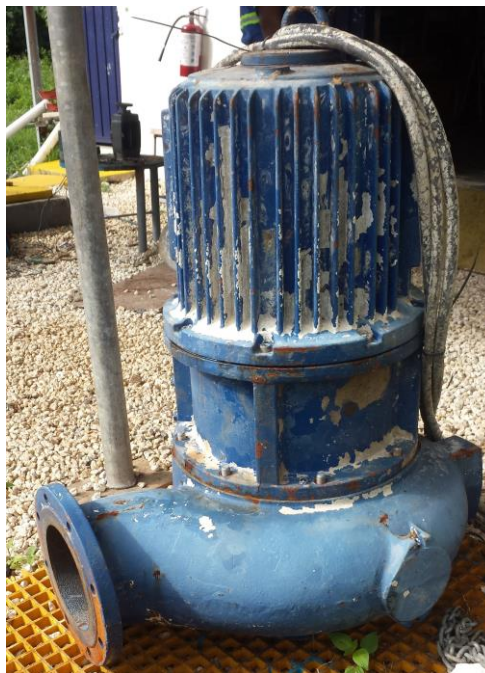
Figura 32. Bomba sumergible de la marca KSB tipo KRT k 200-330/504UG-S
