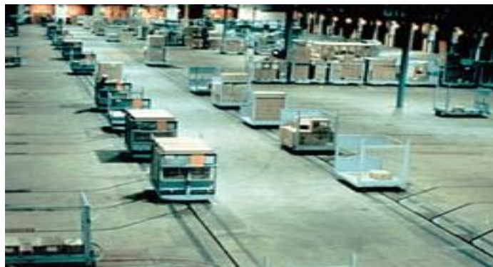
Figura 1.12 Banda por cable enterrado
