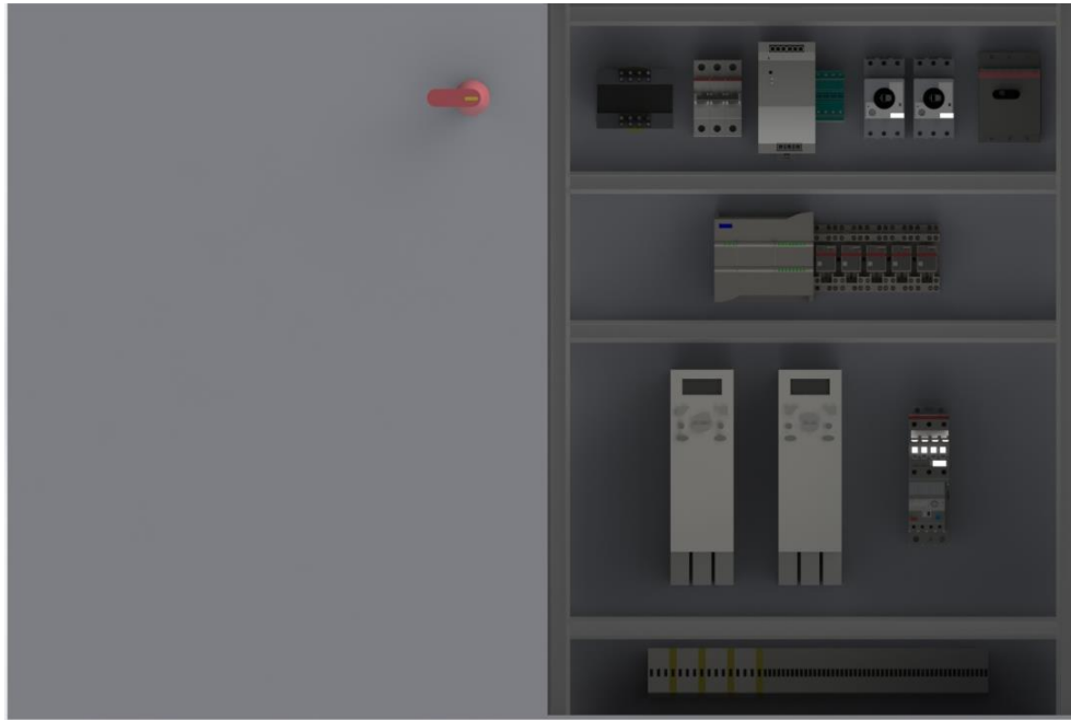
I. Vista Frontal tablero de control
