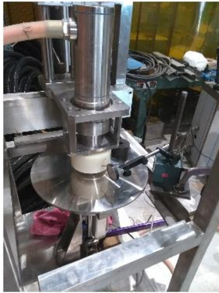
Fig. 66.- Verificación de alineación contra centro de servo.
