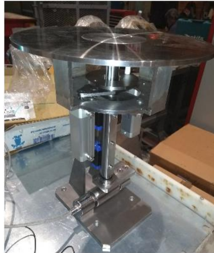
Fig. 62.- Sistema de pesaje y enrollado completo.
