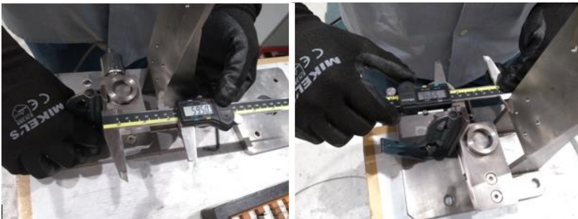
Fig. 65.- Ajuste en posición de placa superior de celda de carga.
