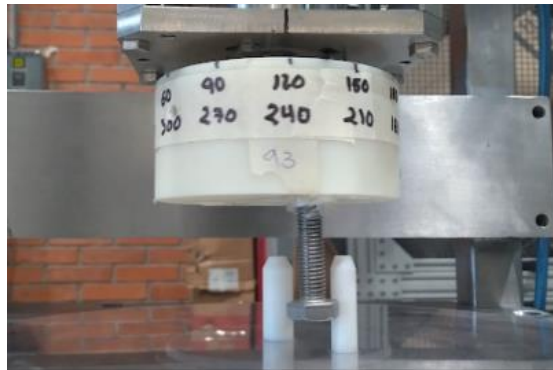
Fig. 79.- Tornillo insertado en servomotor para transmisión de giro.
