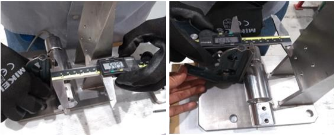
Fig. 64.- Ajuste en posición de celda de carga.
