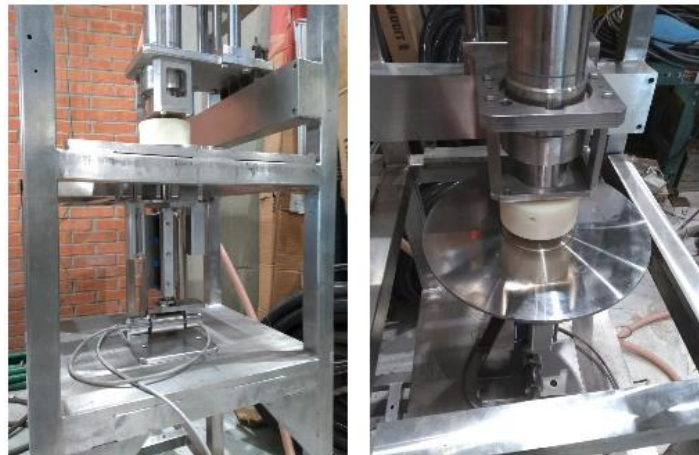
Fig. 63.- Alineación con servo de sistema de pesaje y enrollado.
