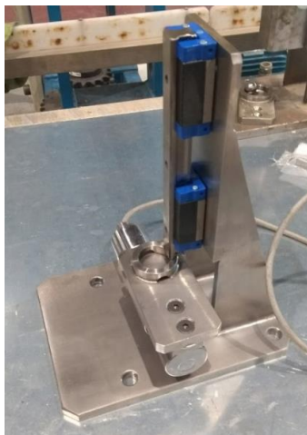
Fig. 61.- Sub-ensamble. Base celda de carga.
