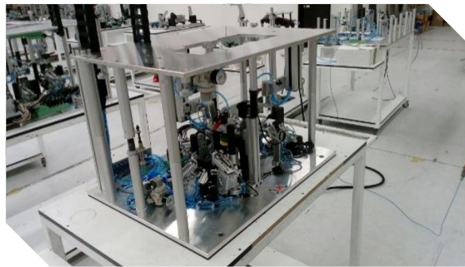
Ilustración 26. Herramental con el ruteo de mangueras y cables
