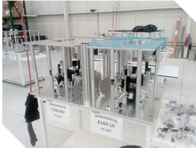
Ilustración 25. Ensamble mecánico del Herramental para la prueba eléctrica
