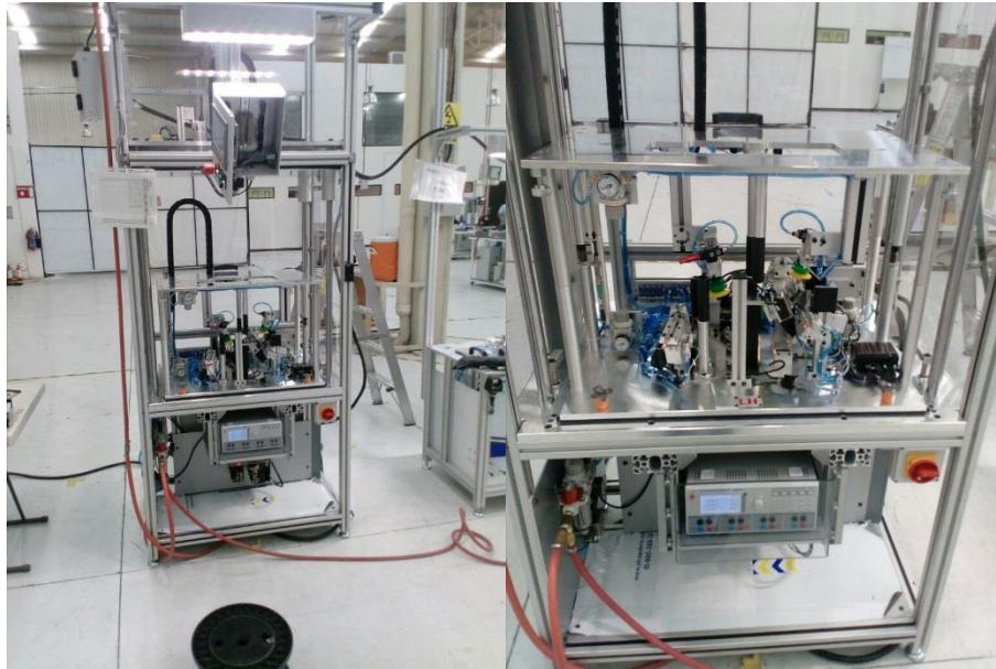
Ilustración 27. Estación de prueba eléctrica con herramental puesto
