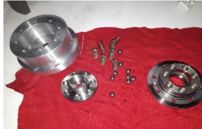
Fig. 72 Componentes de clamp y su respectiva cámara de trabajo
