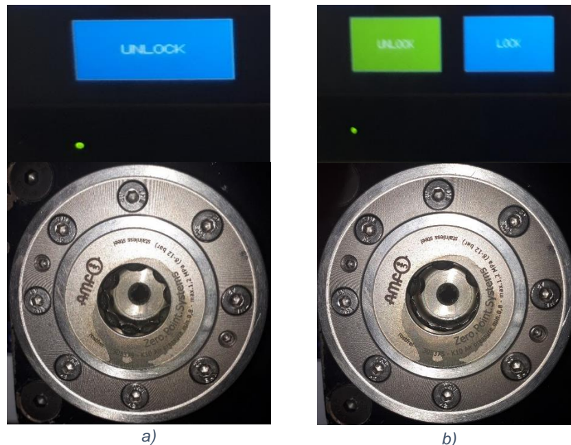
Fig. 57 a) Clamp bloqueado; b) Clamp desbloqueado
