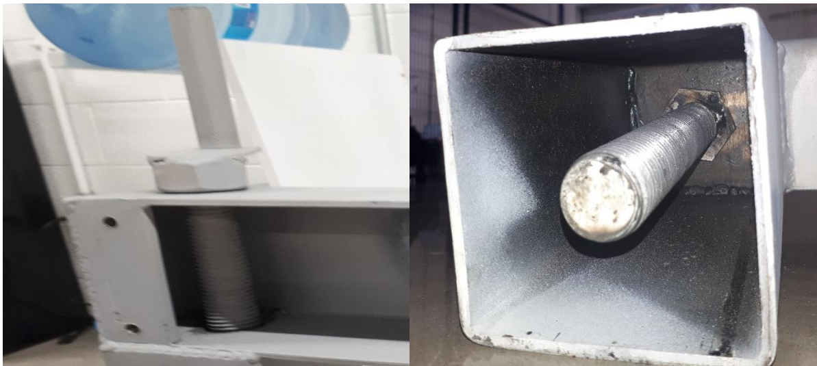
Fig. 24 Tornillo y turca ubicados correctamente
