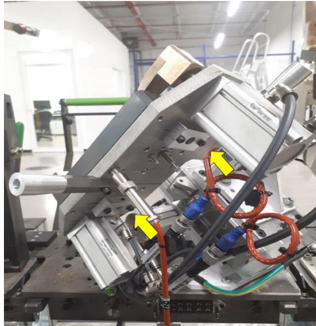
Fig. 54 Bases de sensores montados
