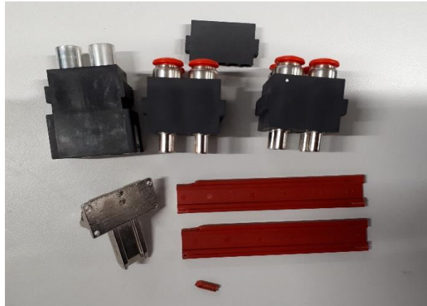
Fig. 18 Elemento fracturado debido a golpes
