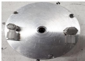
Fig. 73 Cámara con conexiones neumáticas correctas
