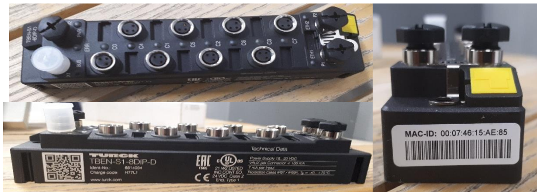
Fig. 38 Características físicas del módulo Turck
