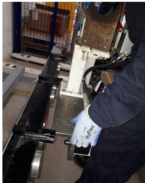
Fig. 17 Técnico acoplando herramental manualmente
