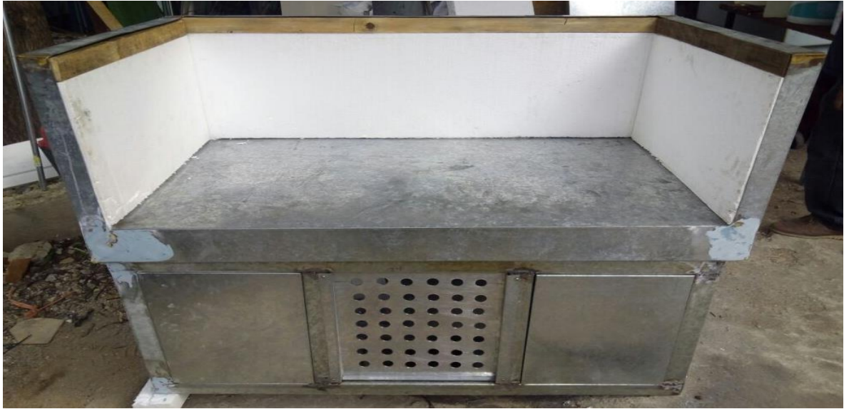
Imagen 4.5: Equipo de refrigeración durante su elaboración.
