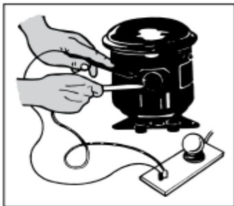
Imagen A18: Prueba de las bobinas del compresor Nota: si la lámpara se enciende la bobina no está interrumpida
