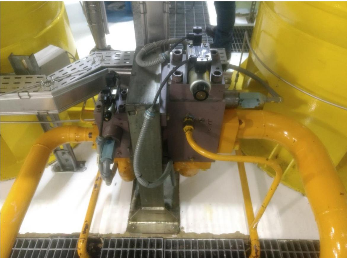
*Figura 32.- Válvula hidráulica direccional 501 de los tanques acumuladores*
