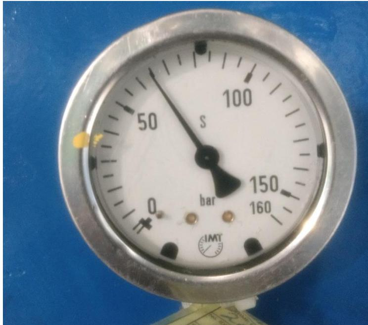
*Figura 30.- Manómetro del tanque acumulador TA*
