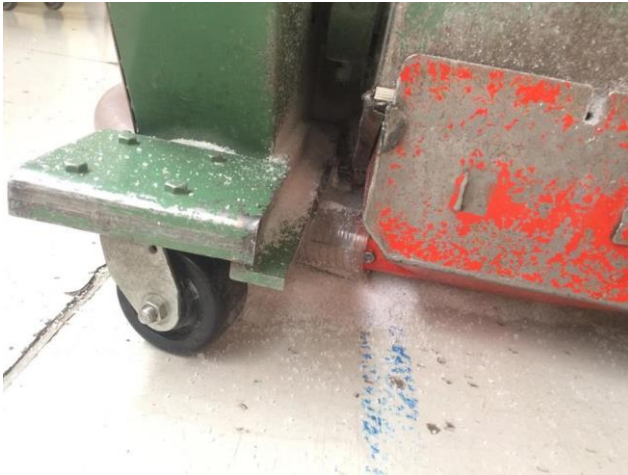
Ilustración 8. Polvo generado por molino Auger.
