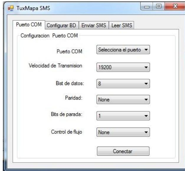
Seleccionamos el puerto de comunicación asignado a nuestro dispositivo para establecer una conexión exitosa.
